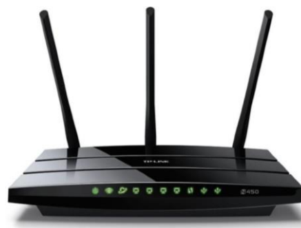
Роутер TP-Link TL-WR942N с тремя антеннами
